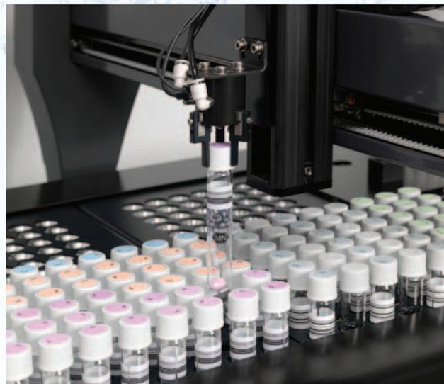
увеличить производительность прибора, используя вторую захват, иглу для отбора пробы и мешалку или выполнение дополнительных задач, таких как, измерение pH или пипетирование проб.
