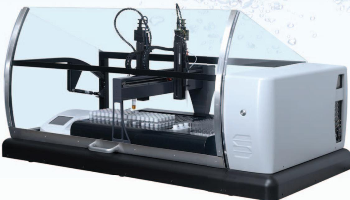
Анализаторы серии SP2000 могут быть сконфигурированы для автоматизации определения ХПК с использованием метода запаянной трубки ХПК (СТ-ХПК) в соответствии с ISO 15705/EPA 410,4 или с классическим методом титрования в соответствии с ISO 6060.
